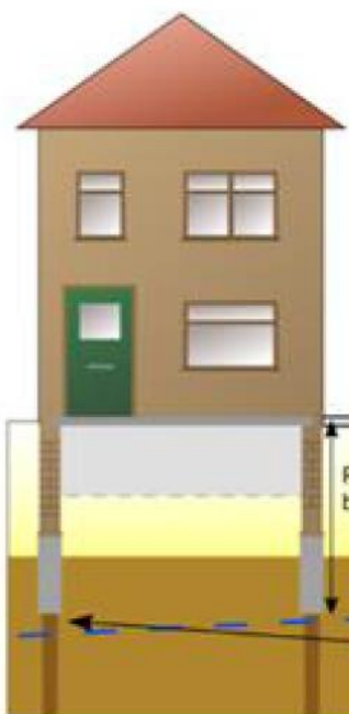
Fundering houten palen met betonopzetters
