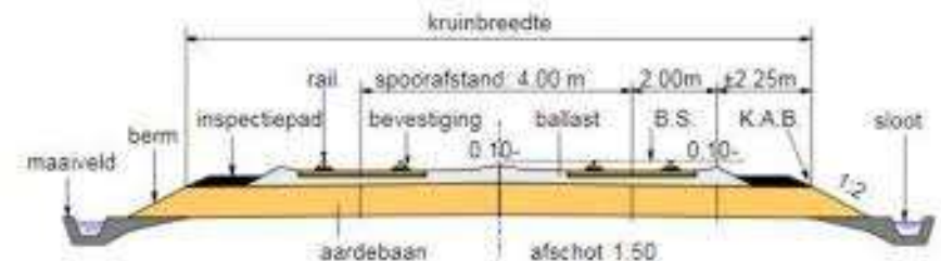
Figuur 60: Dwarsprofiel dubbelsporige spoorbaan in rechtstand en op maaiveldhoogte
